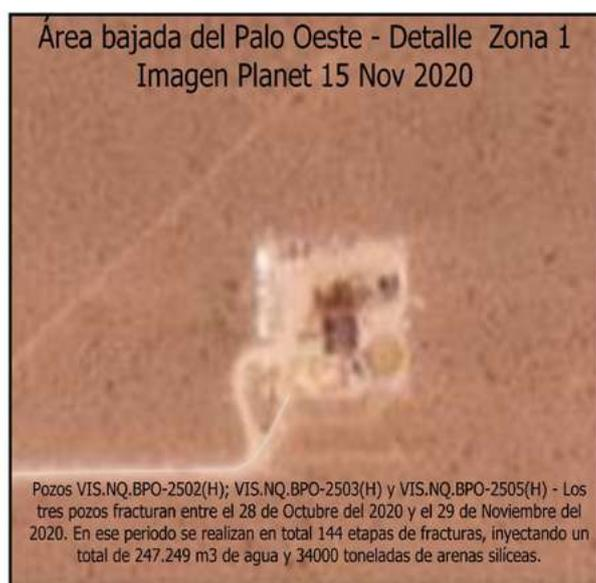
**Figura 4.** Área Bajada del Palo Oeste. Pozos VIS.NQ.BPO- 25XX(H). Los tres pozos fracturan entre el 28 de octubre y el 29 de noviembre del 2020. En este periodo se realizan en total 144 etapas de fracturas, inyectando un total de 247.249 m<sup>3</sup> de agua y 34 mil toneladas de arenas silíceas (datos provisionales). Fuente: Planet 15/11/2020.
